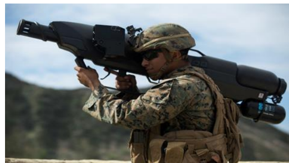
Abbildung Der Skywall 100 ist ein tragbarer Netzwerfer, der Drohnen in einer Höhe von bis zu 100m vom Himmel holt
