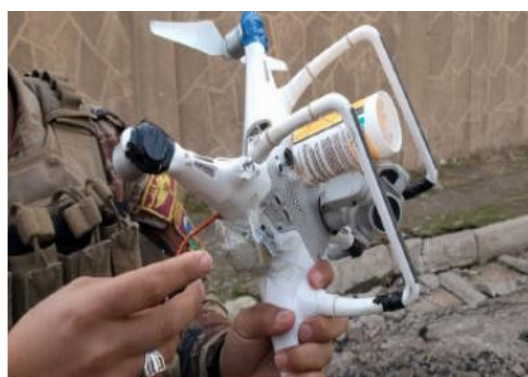
Abbildung Eine durch den IS umgebaute Drohne zum Abwurf von Sprengmitteln. Im Becher (gelb) wird der Sprengstoff transportiert, welcher über dem Ziel abgeworfen wird
